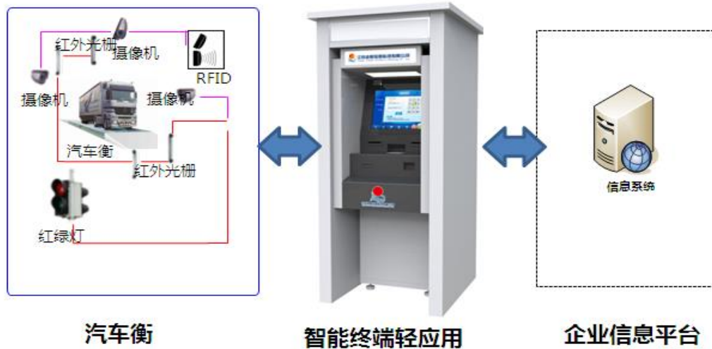
图 2 远程计量系统示意图
