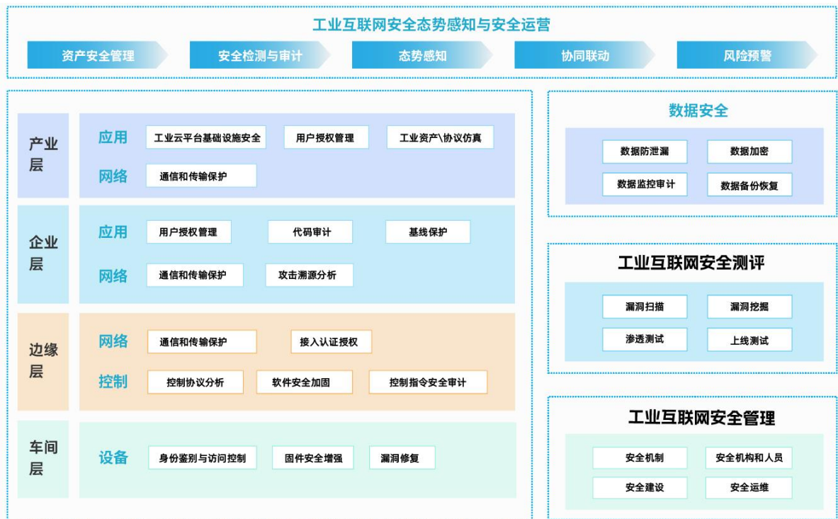
图 4-10 工业互联网安全防护体系建设架构
