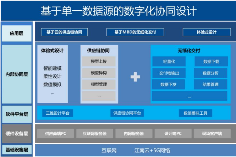
图 1-1 基于单一数据源的数字化协同设计示意图
