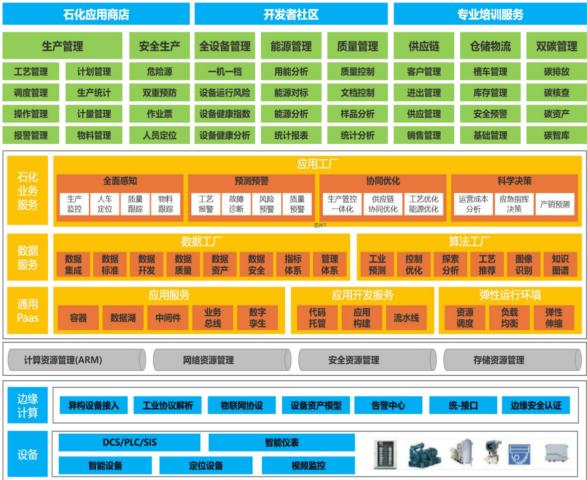
图 4-5 工业互联网平台建设架构图
