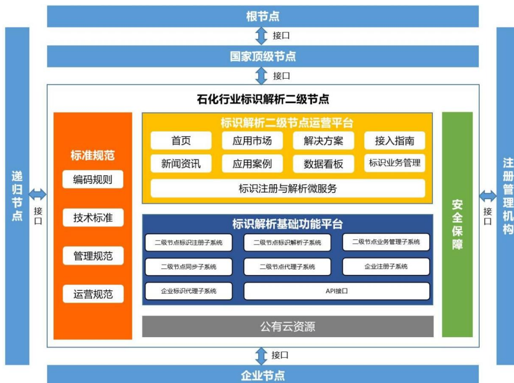
图 1 石化行业标识解析二级节点总体架构图
