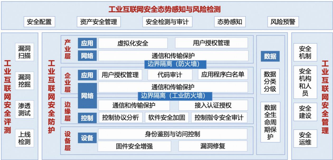
图 4-11 船舶行业工业互联网安全功能架构
