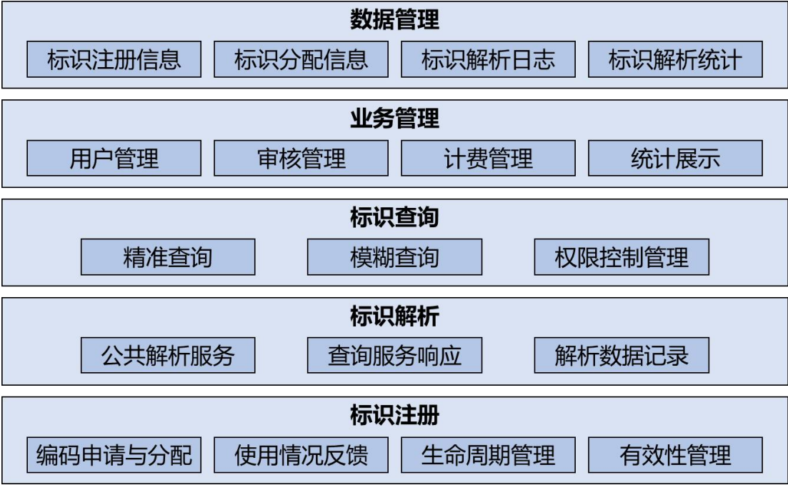
图 4-4 船舶行业工业互联网标识解析功能架构
